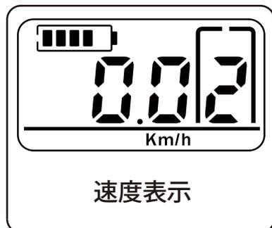
電源ONの状態ですON/OFF(表示切替)ボタンを押すと、速度表示→ODO表示→TRIP→速度表示(以下ループ)と変わります。
