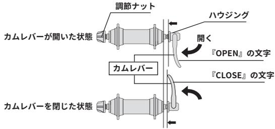
**禁止** フレームに車輪を固定するとき、カムレバーを回して締め付けしないでください。クイックリリースのカム機構が動かなくなり、車輪の固定が不完全になり非常に危険です。
