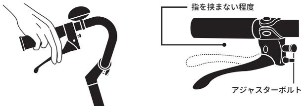
・ブレーキレバーの角度は、サドルに座り腕を延ばしてその延長線上に沿うようにセットします。
