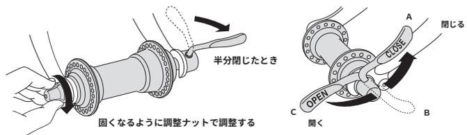
**警告** カムレバーをAの位置まで操作したときに十分固定出来る事が重要です。もし、カムレバーが固すぎたり、緩すぎて固定が十分でないときは、危険ですから調整ナットを回して再調整してください。
