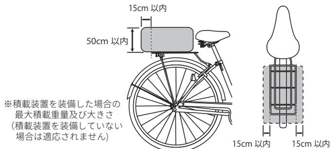
※積載装置を装備した場合の最大積載重量及び大きさ(積載装置を装備していない場合は適応されません)
