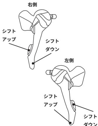
左側の変速機の小さいレバーを内側に押すとフロントディレクターがシフトアップされます。また大きいレバーを内側へ押すとシフトダウンします。
