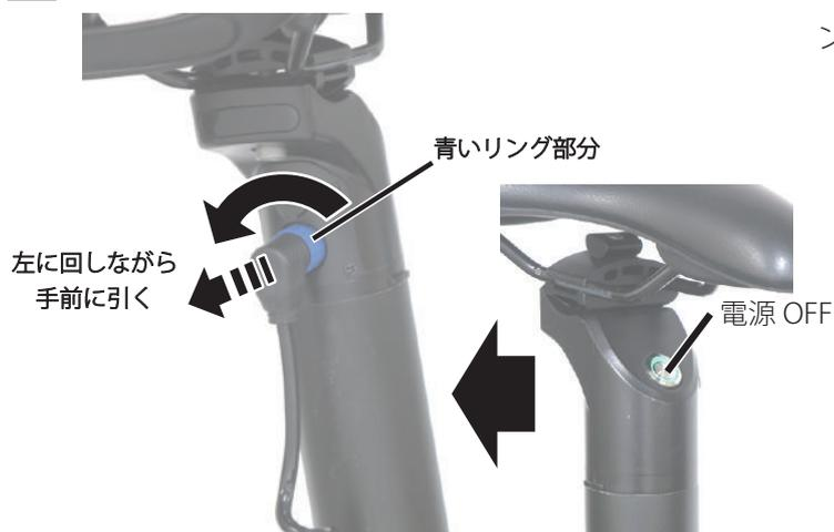
バッテリー電源がオフにしてから、シートポスト背面に接続されているコネクターの根元の青いリング部分を左に回しながら手前側に引き抜きます。
