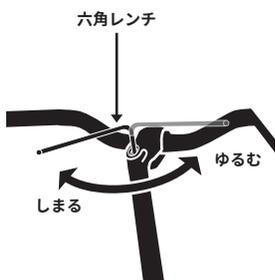
・ボルトの頭に木片などを当てて軽くたたくと固定がゆるみシステムは上下に調整できます。
