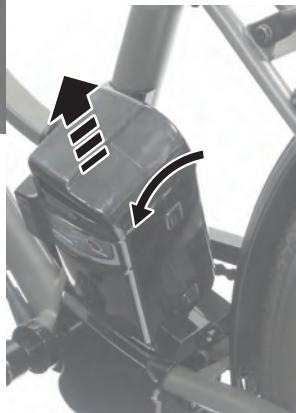
車体の左側面にあるバッテリーの盗難防止用の鍵穴にキーを差し込んで左に回すとバッテリーの施錠が外れます。
