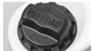
硬さではなく、ばねの余荷重です。これにより、乗員が着座した時のホークのサグ（沈み）が抑えられます。プリロードアジャストノブを時計回りに回すと強まり、反時計回りに回すと弱まります。
