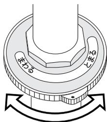
※リングを反時計方向に回しても制御機構が動かない場合はハンドルを少し左右に動かしながらリングを当たりまで回してください。
