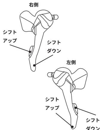
左側の変速機の小さいレバーを内側に押しとフロントディレクターがシフトアップされます。また大きいレバーを内側へ押しとシフトダウンします。
