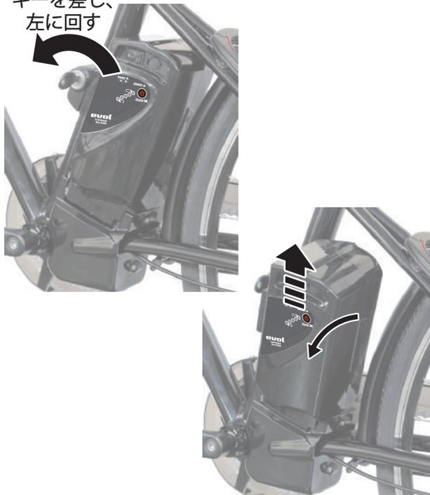
車体の左側面にあるバッテリーの盗難防止用の鍵穴にキーを差し込んで左に回すとバッテリーの施錠が外れます。
