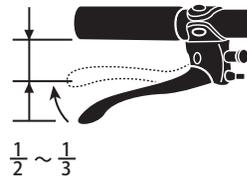
※左のブレーキレバーで後輪、右のブレーキレバーで前輪のブレーキが作動する事を確認してください。
