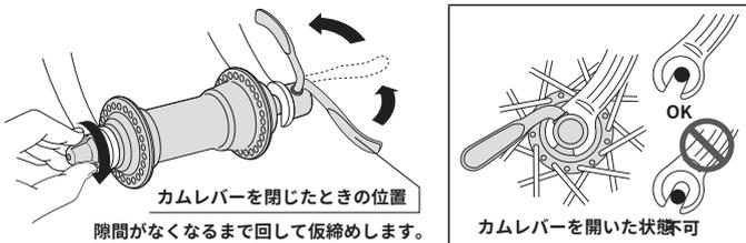
**警告** クイックリリースハブは、車輪の脱着には大変便利に出来ていますが、使用を誤ると非常に危険なものになります。クイックリリースハブの使用法をよく理解された上で取り扱いください。解除している状態では絶対に自転車に乗車しないでください。車輪が外れてしまい危険です。
