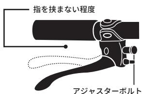
・ブレーキレバーの角度は、サドルに座り腕を延ばしてその延長線上に沿うようにセットします。
