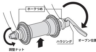
・カムレバーを開いたままにして、エンド（ホークつめ）とクイックリリースの調整ナットとハウジングの隙間がなくなるまで調整ナットを下記左図のように回して締めます。なお、調整ナットの調整をするときのカムレバーの位置は、カムレバーを閉じたときの位置を想定して、下記右図に示す位置で行うのが理想です。
