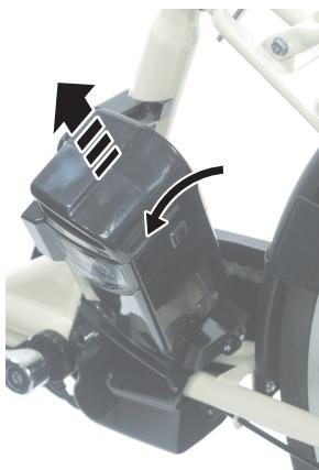
車体の左側面にあるバッテリーの盗難防止用の鍵穴にキーを差し込んで左に回すとバッテリーの施錠が外れます。
