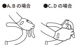
※ブレーキ補助レバーが取り付けられている場合は、Aの位置の時のみそれを用いて制動することができます。
