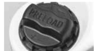
ばねのプリロード（余荷重）を調整することにより、乗員の体重や乗車スタイルに合わせてホークを調整できます。設定するのはコイルばねの硬さではなく、ばねの余荷重です。これにより、乗員が着座した時のホークのサグ（沈み）が抑えられます。プリロードアジャストノブを時計回りに回すと強まり、反時計回りに回すと弱まります。
